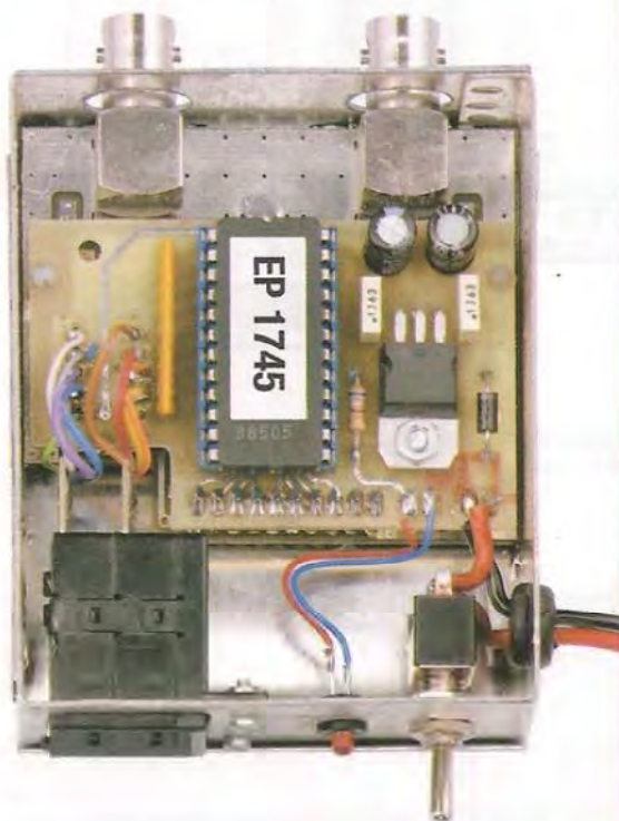
Fig.13 Una volta collocate le due schede KM1745K e LX.1745 all'interno del mobile, dovrete provvedere ad inserire i componenti esterni nella mascherina e a chiuderlo con il relativo coperchio.
