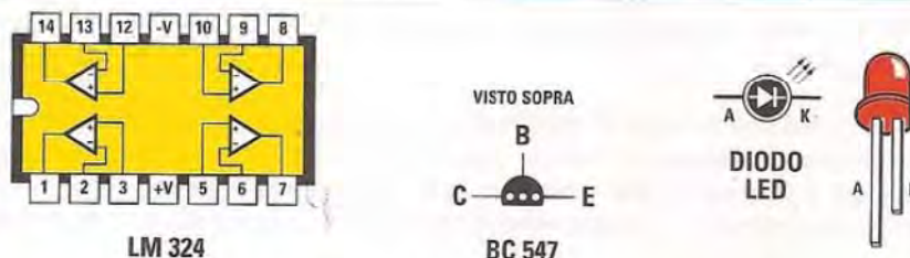
Fig.8 In figura è visibile lo schema a blocchi dell'integrato LM 324, visto dall'alto, con i suoi 4 amplificatori operazionali. A fianco è riprodotto il transistor BC547 visto da sopra, con i suoi tre terminali base (B), collettore (C), emettitore (E) ed il diodo led con la rappresentazione dei suoi due terminali anodo (A) e catodo (K).
