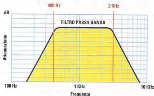
Fig.5 Questo grafico mostra invece la curva di risposta del filtro passa banda. Il filtro passa banda delle nostre luci psichedeliche deve lasciare passare, senza attenuarle, tutte le frequenze comprese tra 400 Hz e 2 KHz (2000 Hz). Questo funzionamento è indicato dalla linea piatta del grafico. Le frequenze inferiori a 400 Hz e superiori a 2 kHz vengono invece fortemente attenuate fino a scomparire, come indicato dalle due linee inclinate poste a sinistra e a destra.
