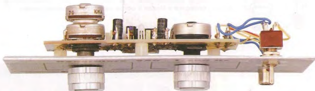
Fig.7 Foto del pannello frontale con sopra fissato il circuito stampato. Il pannello frontale così completato verrà posto sul mobile plastico a consolle (vedi fig.8) con viti autofilettanti.
