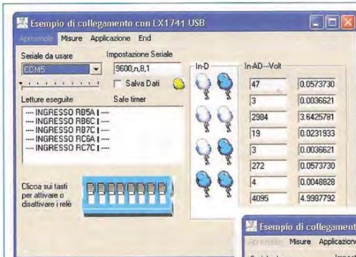
Fig.22 Col mouse cliccate sui deep blu virtuali e se avete la scheda relè inserita udrete il suono del contatto che si apre e si chiude. Abbiamo dotato l'interfaccia della possibilità di salvare i dati in un file.
