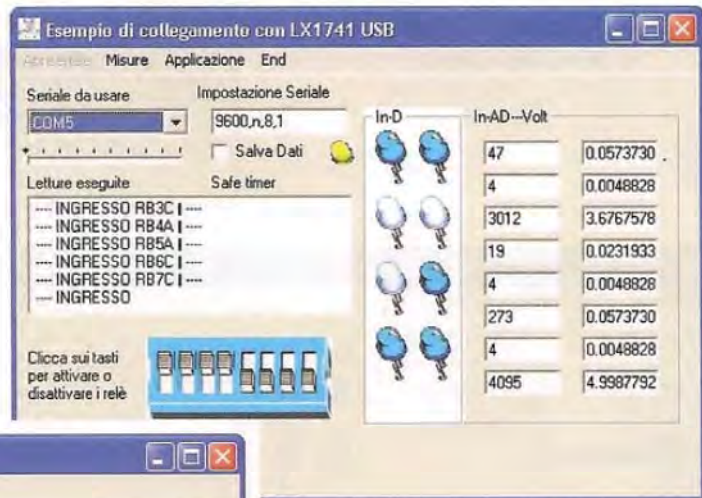
Fig.21 Provate a chiudere gli ingressi digitali, ponendo un ponticello tra +V e S, e vedrete che il led corrispondente si accenderà. Fate diverse prove per verificare la bontà del montaggio.
