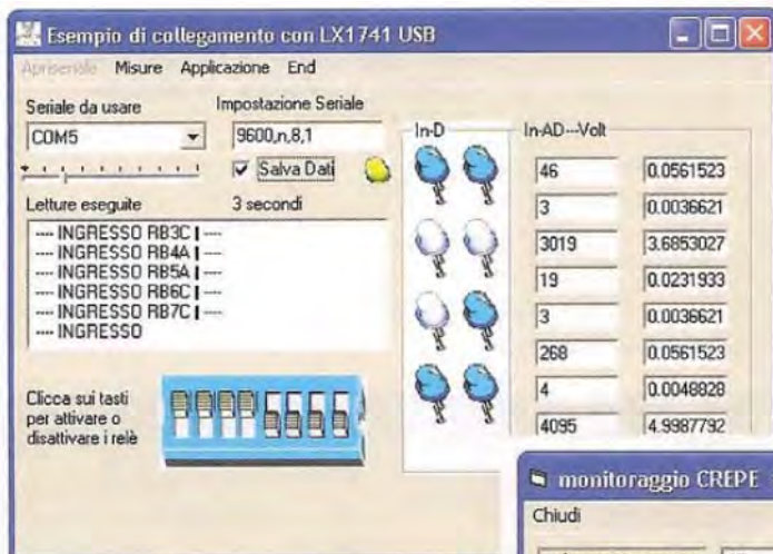
Fig.22 Col mouse cliccate sui deep blu virtuali e se avete la scheda relè inserita udrete il suono del contatto che si apre e si chiude. Abbiamo dotato l'interfaccia della possibilità di salvare i dati in un file.
